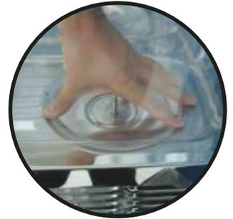
Coloque a bucha de rolamento junto com o impulsor magnético no eixo da depressão onde ocorre o resfriamento, com as lâminas voltadas para cima.
