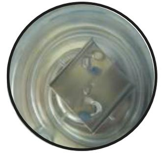
Em seguida, gire 1/8 de volta para a direita (sentido horário). Esta peça é responsável por fixar a tampa do impulsor e o próprio impulsor magnético ao chassi. Certifique-se de que a peça esteja colocada antes de ligar a máquina.
