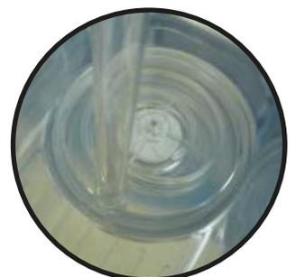
Coloque o fixador do sistema de bombeamento na ponta do eixo do impulsor magnético.
